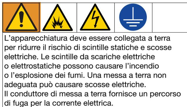
**Sistema:** collegare il filo di messa a terra della sorgente di alimentazione nel quadro elettrico come mostrato in **Collegamento della sorgente di alimentazione**, pagina 20.
